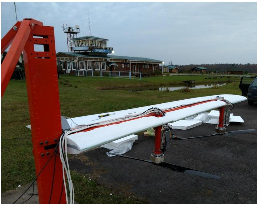
В процессе испытаний была установлена высокая эффективность подъемных винтомоторных групп, расположенных под крылом. Идет обработка данных, полученных в эксперименте, и по результатам испытаний будет выдано заключение.
